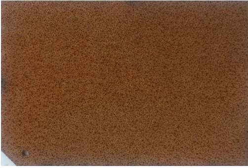
MYND 5 Stálsýni eftir eitt ár í tæringarreka í Reykjavík.
