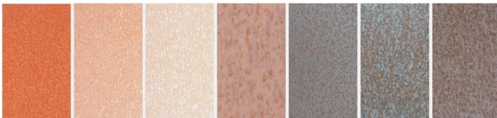
MYND 4 Dæmi um útlit ryðhúðarinnar eftir mismunandi ytri aðstæðum og þroska.
